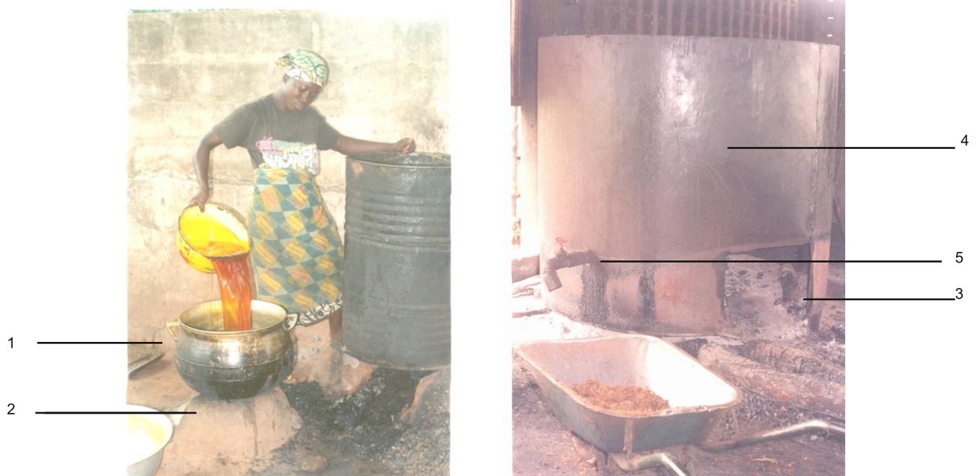
1: Marmite de séchage en aluminium 2 : Foyer en terre de barre; 3: Robinet de récupération de l'huile; 4: Tank de séchage; 5: Chambre de combustion.
