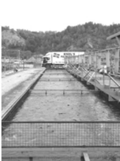
Photo 8: Canal complet de 360 m³ (raceway) avec grilles de séparation (10 à 12.000 poissons entre 2 grilles) et système de distribution automatique d'aliments (à droite)
